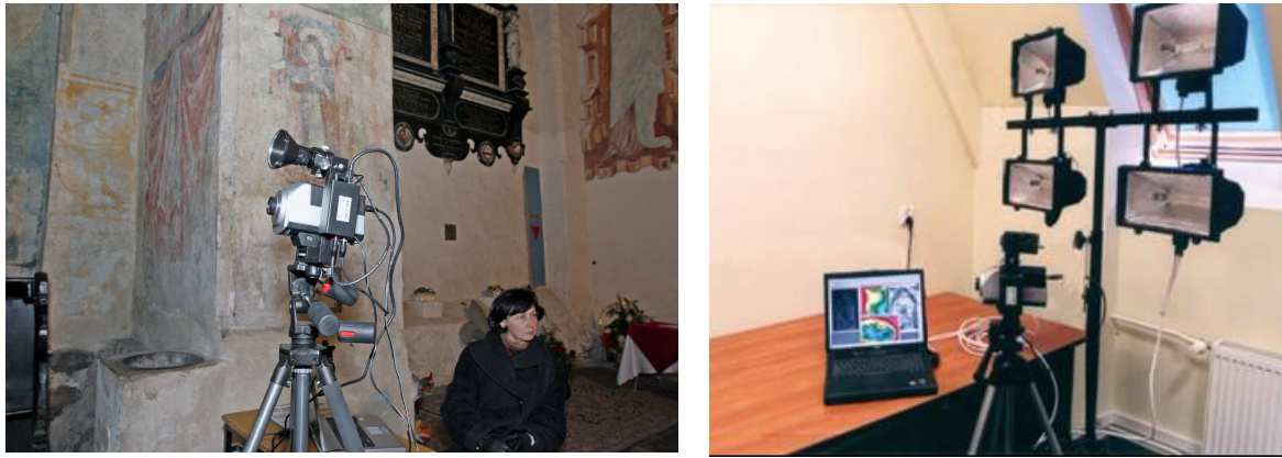
Rys. 7. System termowizyjny do statycznych i dynamicznych badań obiektów zabytkowych
