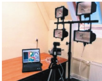
Rys. 15. Koncepcja metody fali cieplnej i komputerowy system termografii aktywnej i pasywnej wraz ze źródłami energii świetlnej
